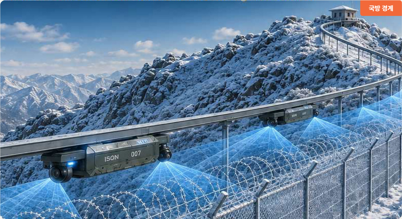
험준한 산악·혹한 환경에서도 Positive Drive 방식으로 급경사를 주행하며 24시간 순찰합니다. ( EO/IR 주야간 감시와 BLE 기반 음성통신으로 경계 공백을 최소화합니다. )
